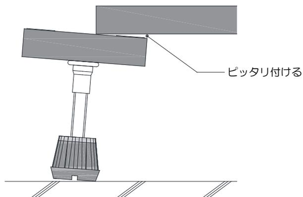
**注意** ボルトが台座から出る場合、防振ゴムの底部に接着剤を付けながら、施工してください。
