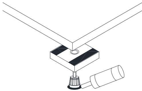
**注意** 接着剤注入後に接着剤の確認ができない箇所も、防振ゴムの底部に接着剤を付けながら、施工してください。
