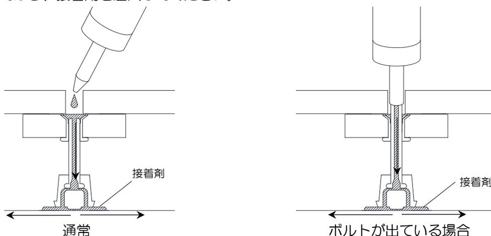
ボルトが出ている場合は、ボルトの頭部にノズルを挿して注入します。
