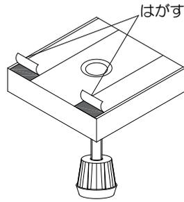
③台座を廻し支持脚を適切な高さに調整します。
