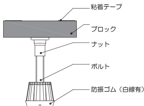
**確認事項** 形状はYPE型支持脚と同じですが、防振ゴムの硬度は70° ±5° です。通常のYPE型支持脚とは、ゴム硬度が異なりますので、注意してください。防振ゴムに白線のマーキングが有ることを確認してください。URの仕上げ高さの基準は、基準階でH=100～140mm（1階・水廻りは100～240mm）を標準としています。それ以外の高さも対応可能ですが、監督員と協議して決めてください。
