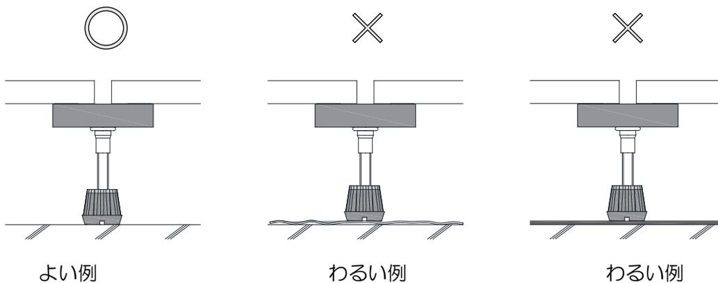
⑥パーチを1枚張るごとに、水平器またはレーザー水平器でパーチを水平にします。
