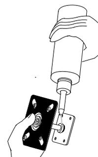
手に持った支持脚を回しながら、加締めカラーの周囲に接着剤を塗布します。
